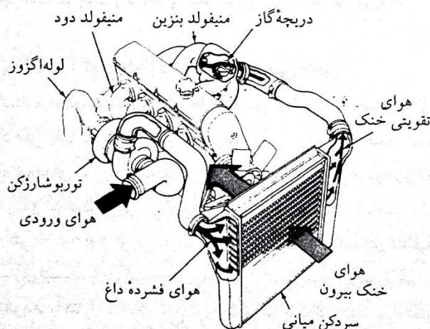
شکل ۱۴-۱۵ موتور توربوشارژر دار. پس از آنکه توربوشارژر هوا را فشرده ساخت، سردکن میانی آن را خنک می‌کند.
