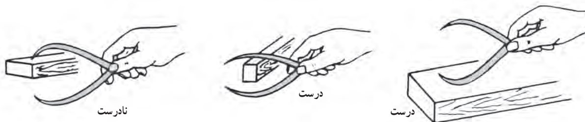
شکل ۲-۲۷- تنظیم دهانه پرگار انتقال اندازه خارج
