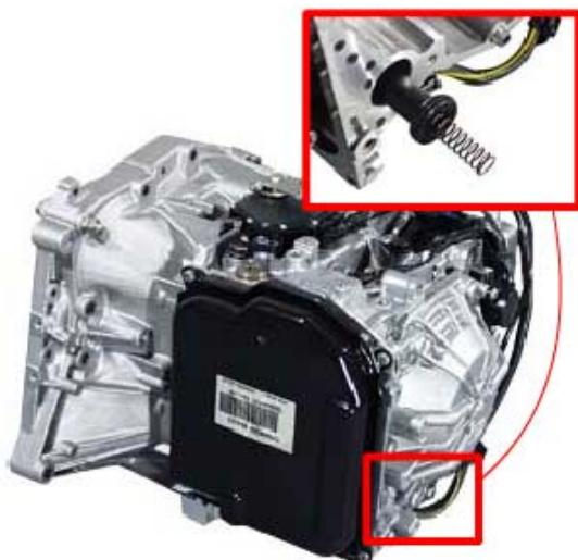
آکامولاتور(انباره)هیدرولیکی: از یک پیستون و یک فنر تشکیل شده است که در پوسته اصلی قرار گرفته است و از طریق قاب پوسته قابل دسترسی می باشد. آکامولاتور باعث می شود تا فشار در کلاچ و ترمز به آرامی بالا برود و در واقع به صورت یک ذخیره کننده فشار عمل می کند.
