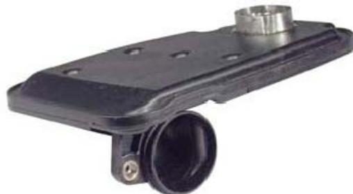
فیلتر: در پایه پمپ روغن را از قسمت پایینی گیربکس دریافت کرده و ذرات معلق آن را جدا می کند. این فیلتر به صورتی طراحی شده که در طول عمر خودرو نیازی به سرویس ندارد. همچنین در این فیلتر یک آهن ربا برای جذب ذرات فلزی قرار داده شده است.
